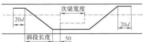
图 B-35 梁内吊筋
